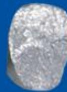
压缩后铸铁试件
