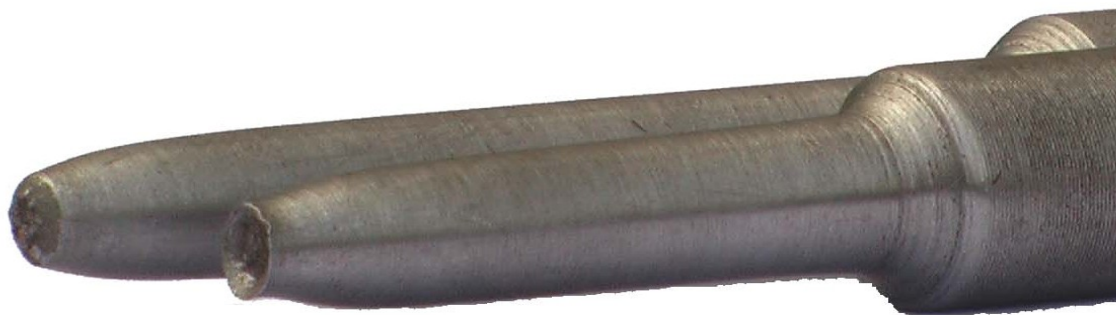
图 1.4 低碳钢 Q235 试件拉伸实验断口形式
