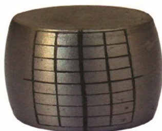
图 2.4 低碳钢 Q235 试件压缩实验变形过程
