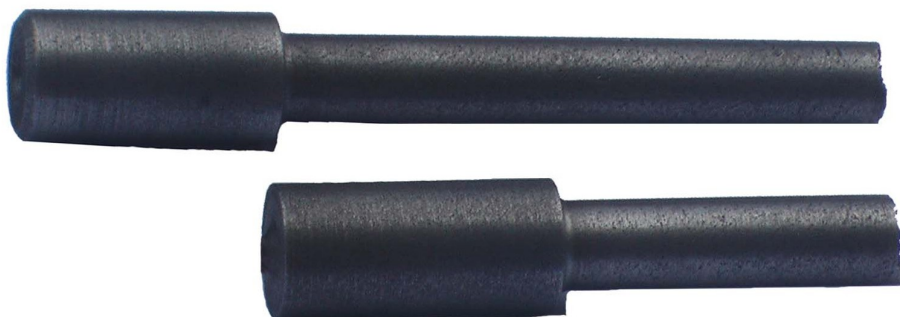
图 1.5 铸铁 HT200 试件拉伸实验断口形式
