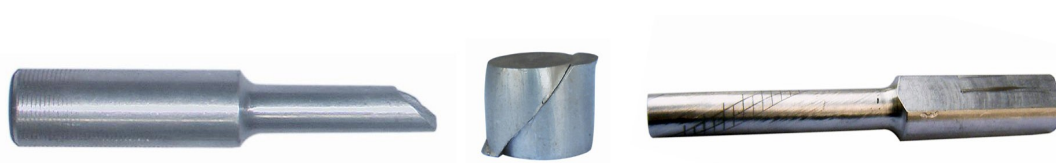
图 8.3 LY12 铝合金试件拉、压、扭断口
