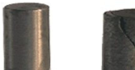
图 2.5 铸铁 HT200 试件压缩实验破坏现象
